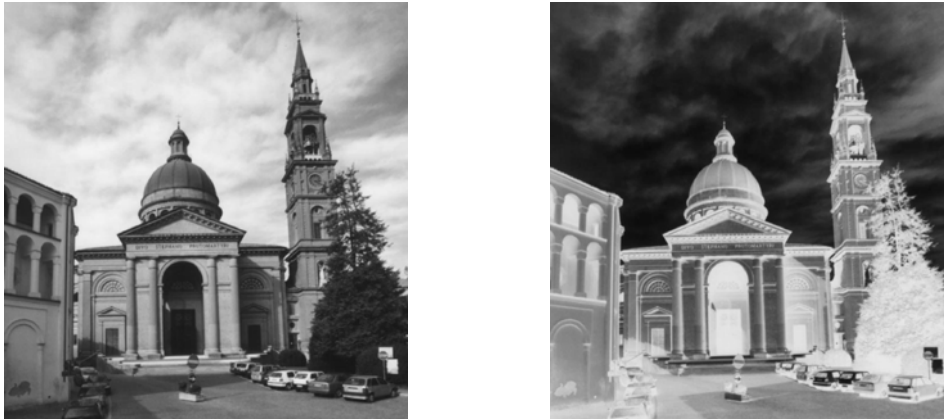
Figura 1.3: Immagini ad 8 bit, in cui la luminosità di ogni pixel (elemento fondamentale componente l'immagine stessa) è rappresentata con un valore da 0 a 255. In particolare, a sinistra è la codifica diretta (0=nero, 255=bianco) e a destra l'applicazione della visualizzazione secondo la codifica inversa (0=bianco, 255=nero) alla stessa immagine, che risulta visualizzata in negativo.
